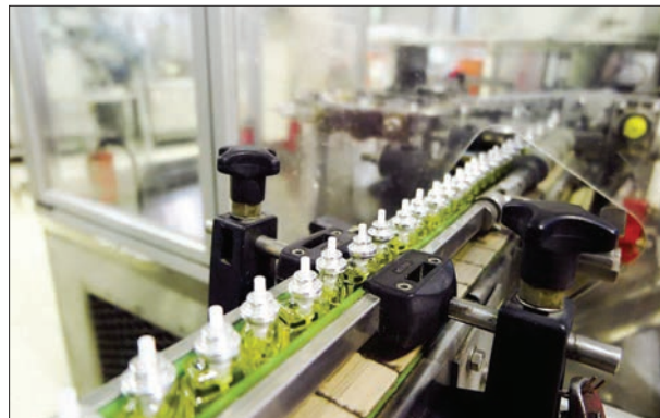
روی شیشه های پر شده عطر در مرحله بعد به صورت اتوماتیک اسپری جای میگیرد
