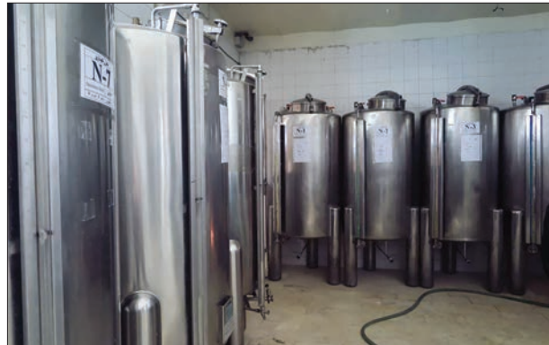
مواد اولیه لازم برای تولید عطر مانند الکل، آب مقطر، اسانس و... قبل از ترکیب در مخازن نگهداری می‌شوند
