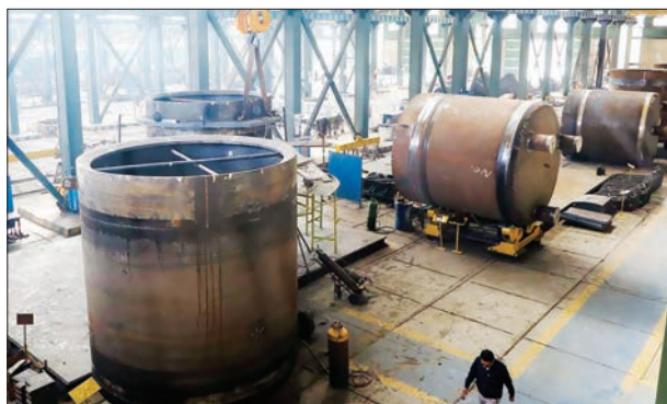
پاتیل‌های بزرگ حمل و ذوب یکی از کارخانه‌های فولاد در وسط خط سه در حال ساخت هستند.
