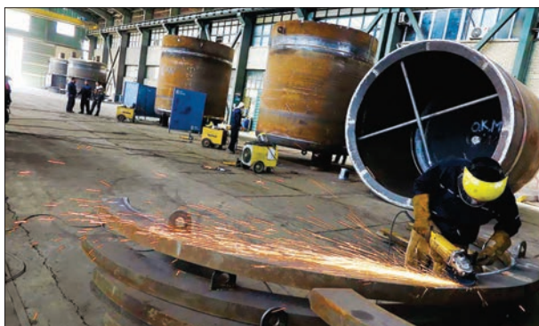
کارگر کارخانه با دستگاه فرز لبه‌های قطعات ساخته شده را برای جوشکاری بهتر صیقل می‌دهد.
