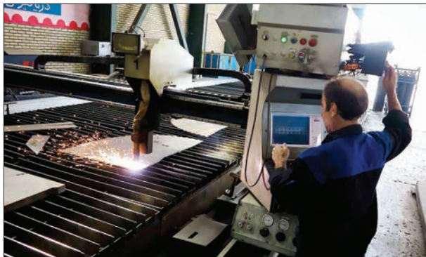
کاربر دستگاه ساینسی در حال برش قطعات فلزی نسبت به نقشه‌ای است که به او تحویل شده است.
