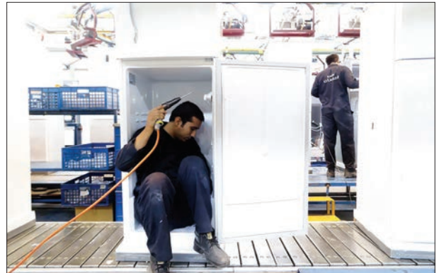
یکی از کارگران با قرار گرفتن داخل بدنه یخچال درحال اتصال در به بدنه است.
