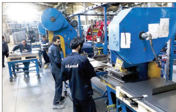
ورق‌های فلزی که از کارخانه‌های مختلف همچون ذوب آهن اصفهان به مجموعه آورده می‌شوند در دستگاه‌های ویژه خم می‌شوند و شکل می‌گیرند.
