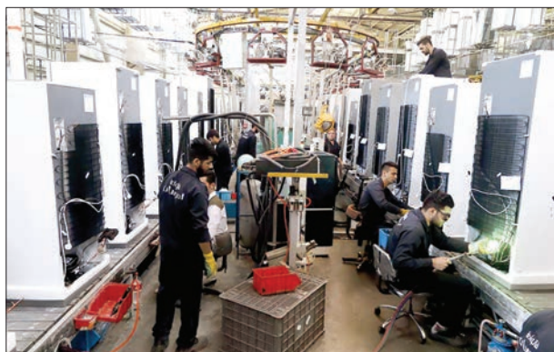
با به پایان رسیدن ساخت بدنه یخچال‌ها تجهیزات مختلف همچون کمپرسور و... به بدنه متصل می‌شود.
