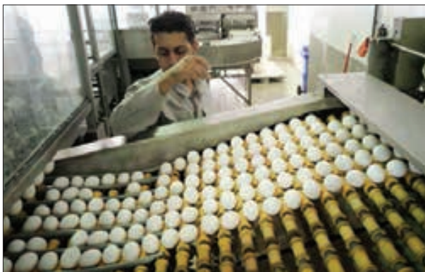
در خط تولید بسته بندی تخم مرغ تلاوتنگ هر ساعت ۱۶۰ هزار تخم مرغ امکان بسته بندی دارند.
