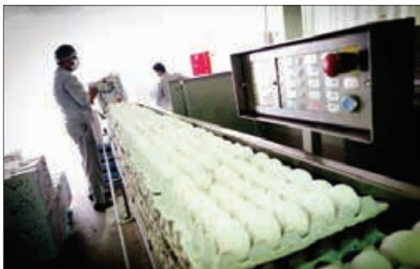
تخم‌مرغ‌ها در ردیف‌هایی منظم روی غلتک قرار می‌گیرند تا از نظر کیفیت سنجیده شوند.
